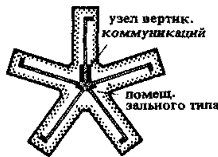
5. Пятилучевое в плане здание со срезанными входными углами, к которым целесообразно примыкание более крупных помещений и др. (см. рис. 6)
