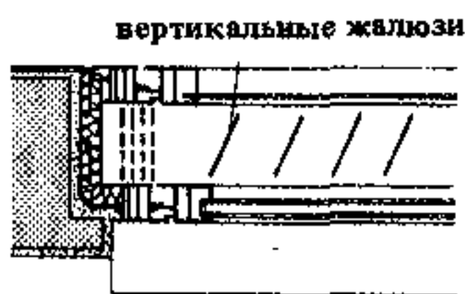
3. Оконные элементы с жалюзиными решетками, боковые откосы начинаются от наружного подоконника. Выпускаются сборные переплеты из пластмассы стандартных размеров. Вертикальный и горизонтальный разрезы
