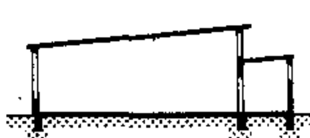
5. Наклонное положение покрытия более благоприятно, поскольку свет распределяется равномернее, чем в здании с горизонтальным перекрытием (рис. 3)
