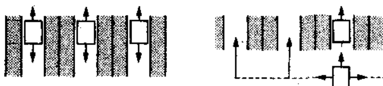
5. Транспортно-подъемные механизмы в каждом проходе между стеллажами (слева). Один транспортно-подъемный механизм, используемый для движения между стеллажами как в продольном, так и в поперечном направлениях (справа)
