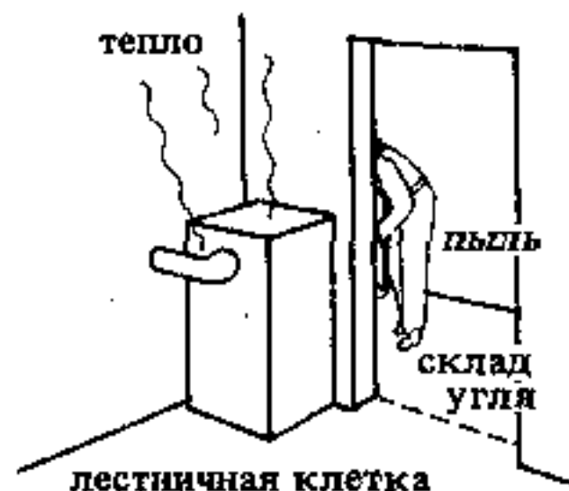
7. Котел может быть установлен в лестничной клетке с топкой из подвального помещения; при этом ниль остается в подвальном помещении, а тепло поступает в лестничную клетку
