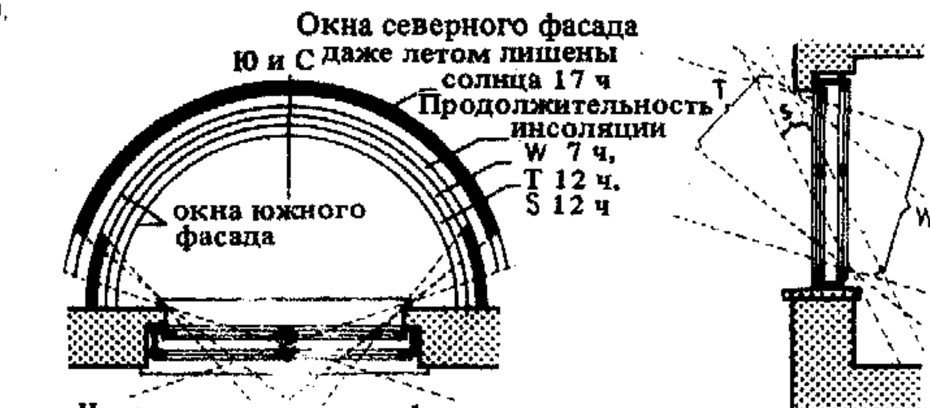
3. Южная ориентация окон целесообразна для помещений, нуждающихся в инсоляции как летом, так и зимой. Справа разрез
