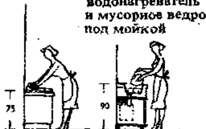
10. Обычная высота рабочего стола 85 см является средней величиной между удобными высотами столов для разделки теста и мойки
