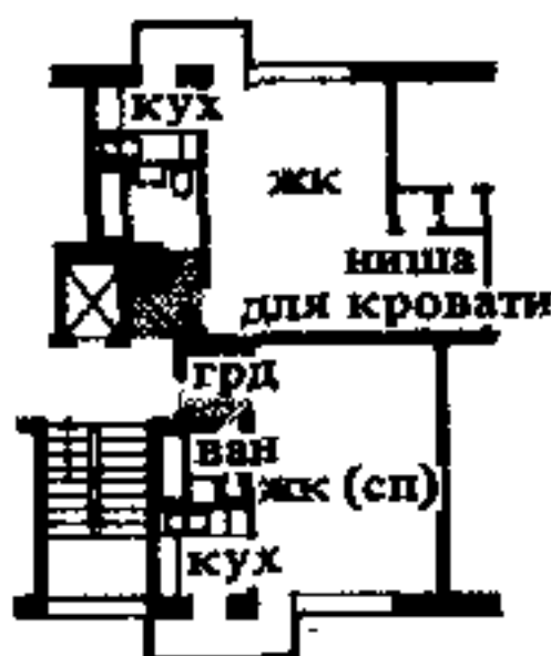
3. План датского секционного многоквартирного дома с небольшой кухней. Ванная освещается вторым светом через кухню. Архитекторы К. Фискер и Ф. Мёллер
