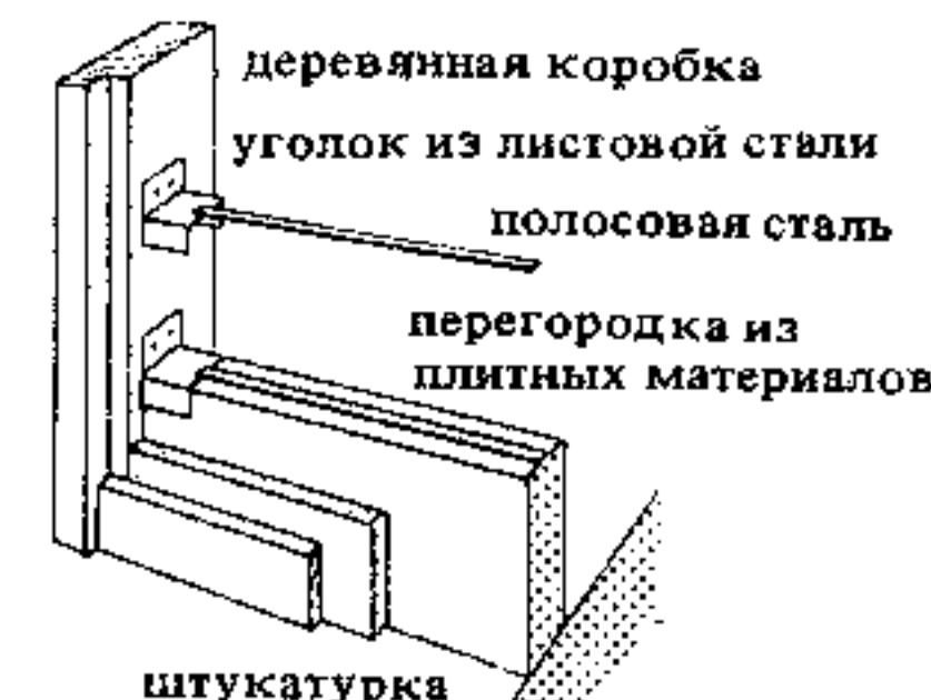
11. Крепление дверной коробки и перегородки
