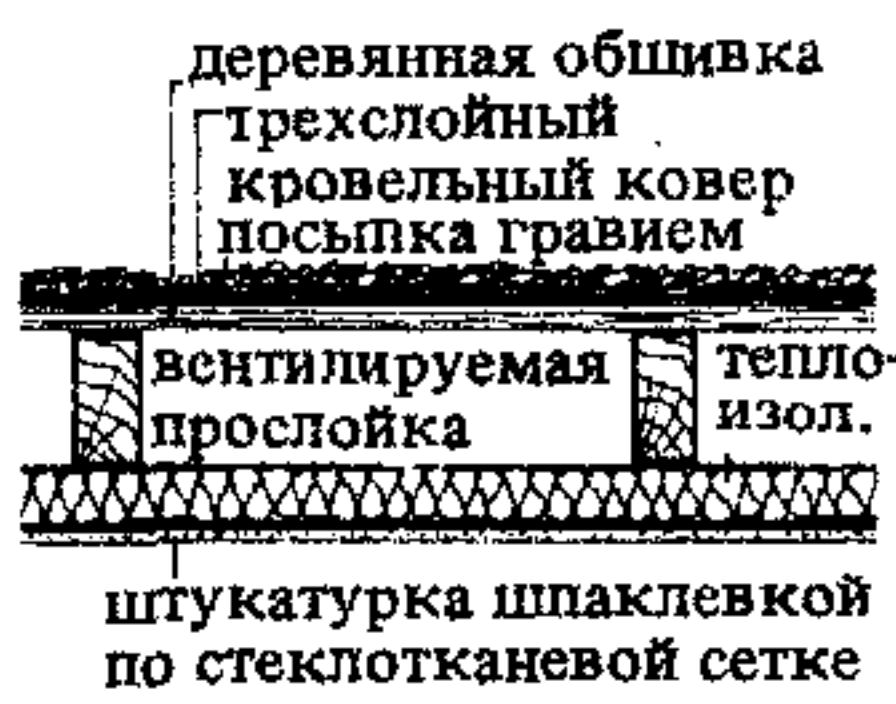
6. Холодная крыша легкой конструкции
