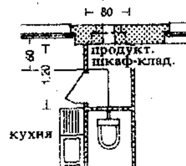
5. Очень большая кладовая для продуктов в домах без подвала. Максимальная площадь пола, которая хорошо освещена благодаря размещению окна против двери
