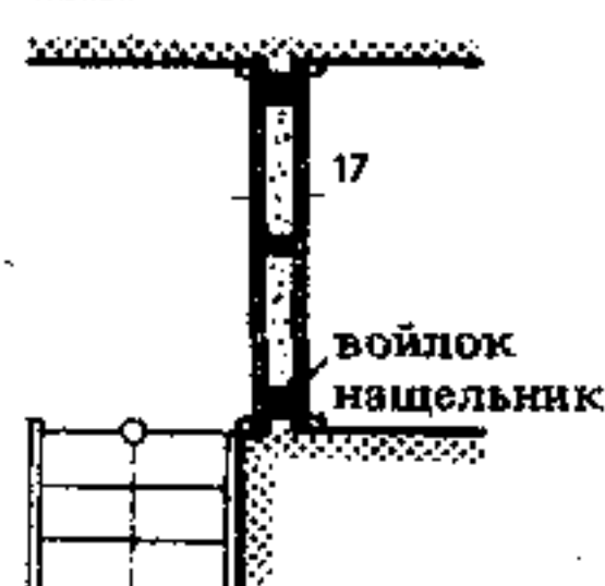
29. Аналогично устраиваются и перегородки; они прижимаются «распор» к боковым стенам с прокладкой войлока
