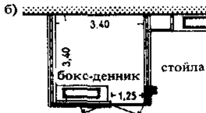
11. Обычное размещение лошадей - кормушки у наружной стены и загрузка кормушек из стойл, как показано на рис. 4, 6, а и б; размещение с проходом позади кормушек (рис. 6, в и 11, а) лучше, но требует большей площади. Для кобыл
