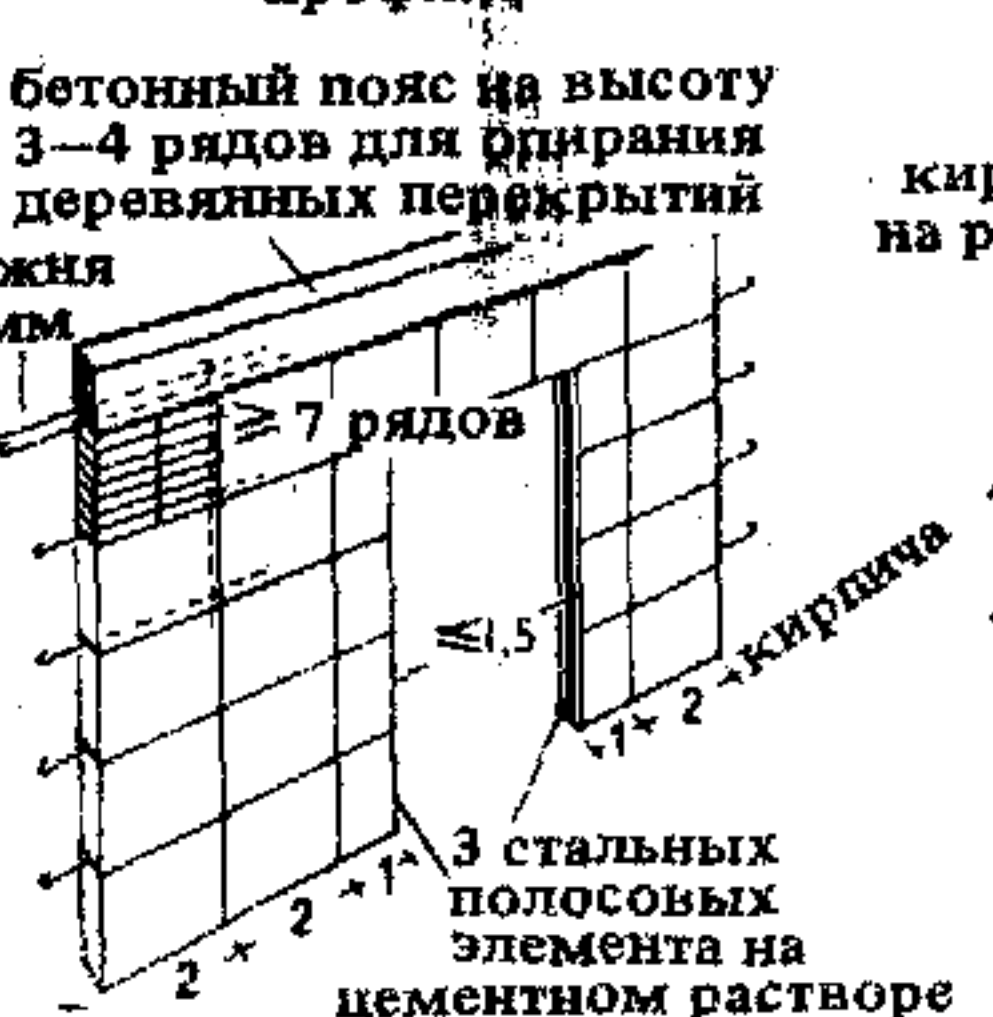
11. Перегородка-балка толщиной 6,5 см, сделанная в стены (система Прюсс)
