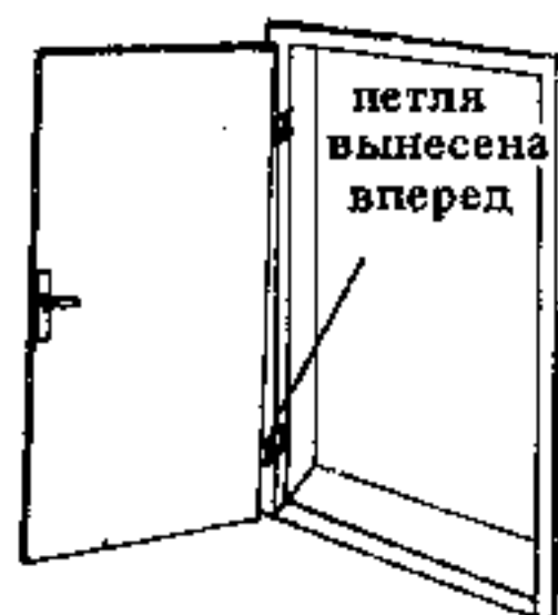
9. Правильно навешенная дверь. При открывании полотно двери немного поднимается вверх
