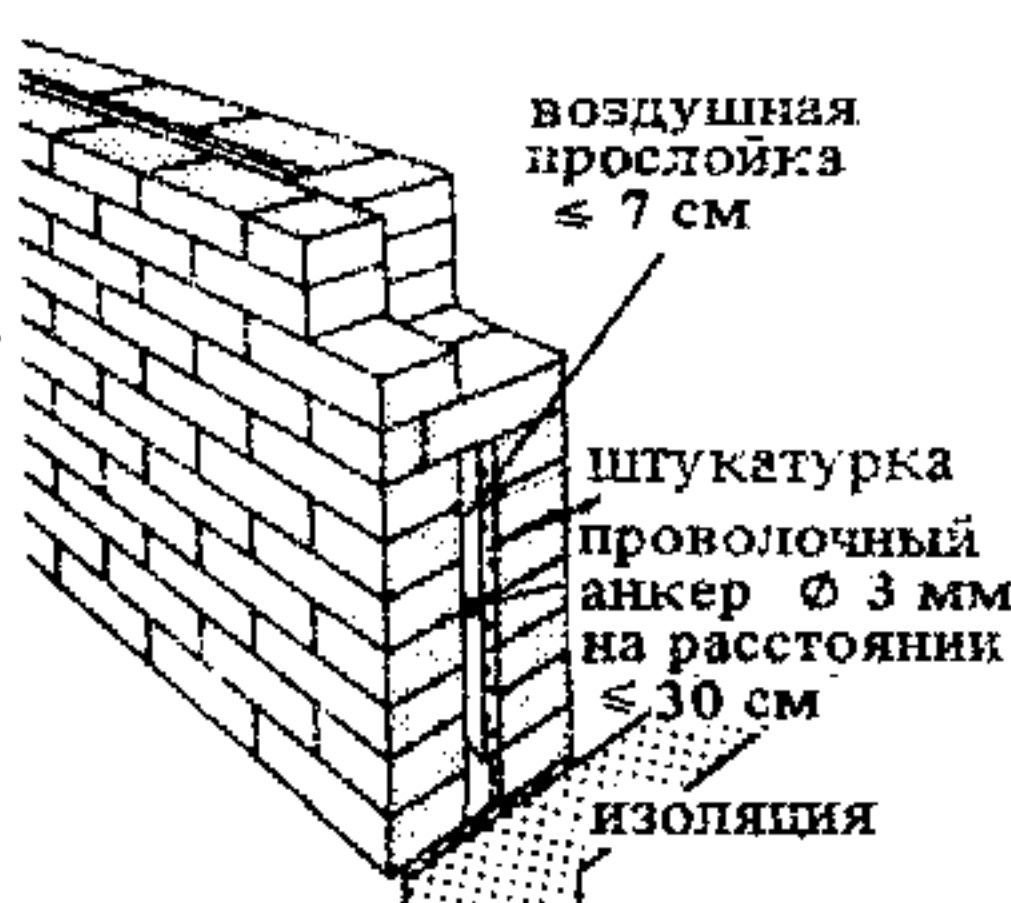
2. Облегченная кирпичная стена с воздушной прослойкой
