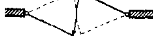
15. Одно- и двухстворчатая качающаяся дверь, при необходимости для привостороннего движения
