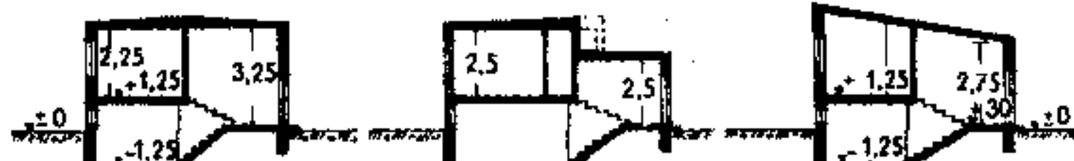
5. Простейшая схема дома со смещенными этажами и высоким жилым помещением (полтора этажа) на рис. 5-7 показаны целесообразные типы домов со смещенными этажами (поперечные разрезы). По материалам архит. О. Фельккерса
