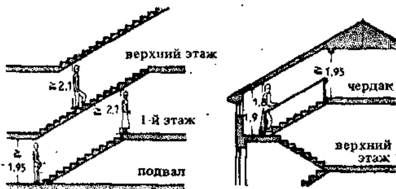
1. Расположение лестниц друг над другом позволяет экономить строительный объем здания (размеры в м)
