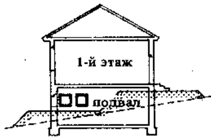
2. При небольших уклонах путем подсыпки вынужденной земли можно создать на участке террасы
