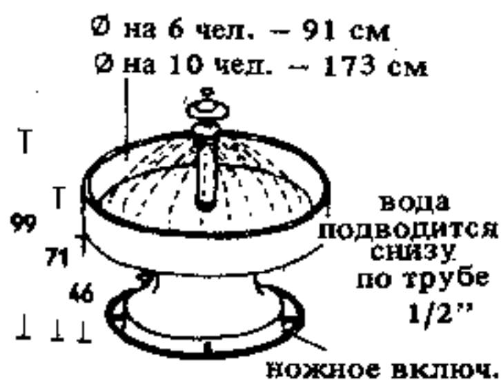
14. Круговой умывальник фонтанного типа (система Брэди) занимает на 25% меньше места, чем умывальники корытного типа. Расход воды для 10 чел. 15-30 л/мин. Напор в сети больше или равен 1/2 атм (см. рис. 17)
