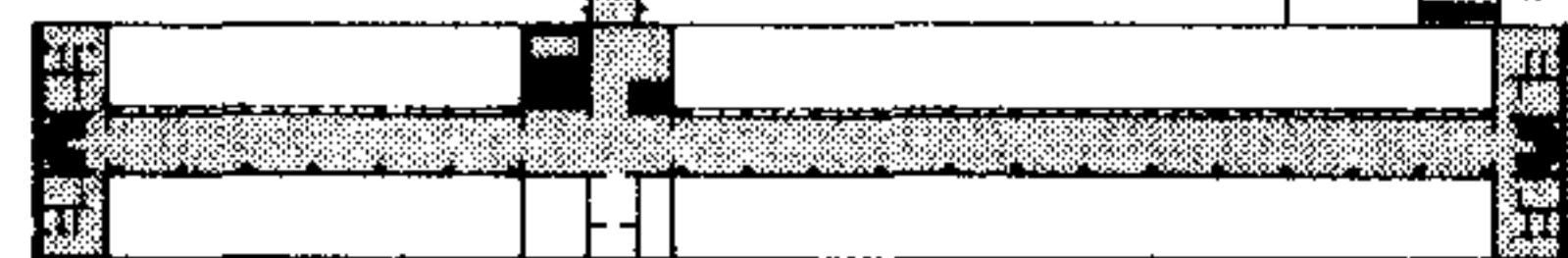
9. Разделение здания на зоны по функциональным признакам (см. рис. 7, 8). Посетители обслуживаются на 1-м этаже конференц-залы отделены от главного корпуса и расположены в самостоятельном блоке. Архит. А. Якобсен
