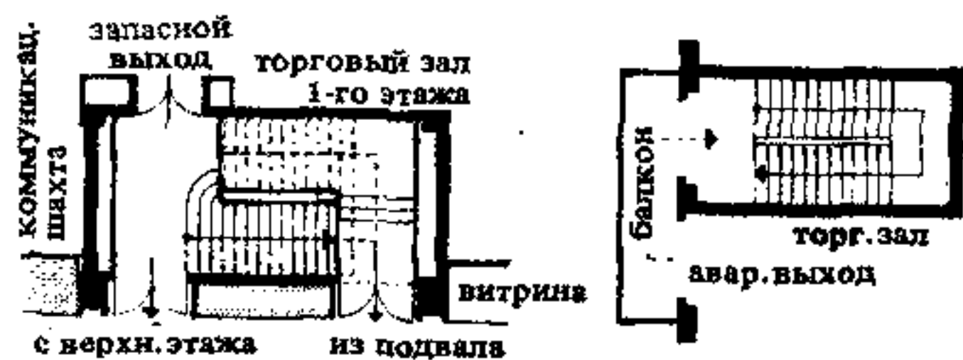
1. Устройство раздельных выходов из подвала и верхнего этажа в одной лестничной клетке
