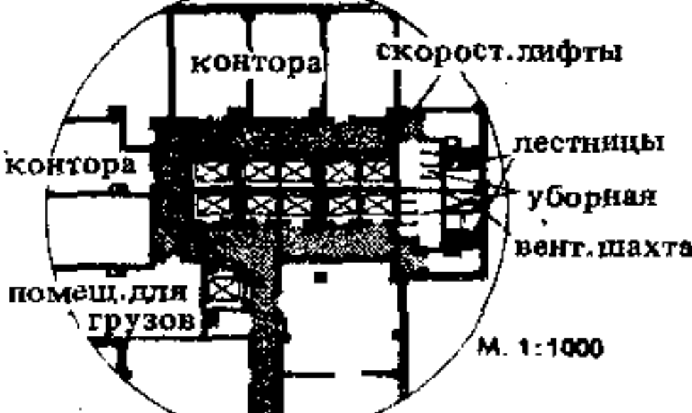
17. Скоростные лифты останавливаются только на каждом 5-м или 8-м этаже; здесь пассажиры пересекаются в обычный лифт. М 1:1000
