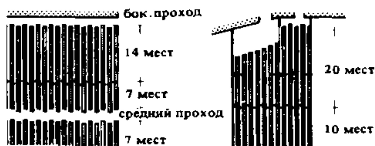
5. В том случае, когда партер расположен в уровне 1-го этажа и если боковые проходы могут выходить до 14 зрителей с мест каждого ряда, на площадки у мест выхода - до 20 зрителей с мест каждого ряда. В средние проходы может выходить вдвое меньше зрителей, чем в боковые проходы и на площадки у мест выхода
