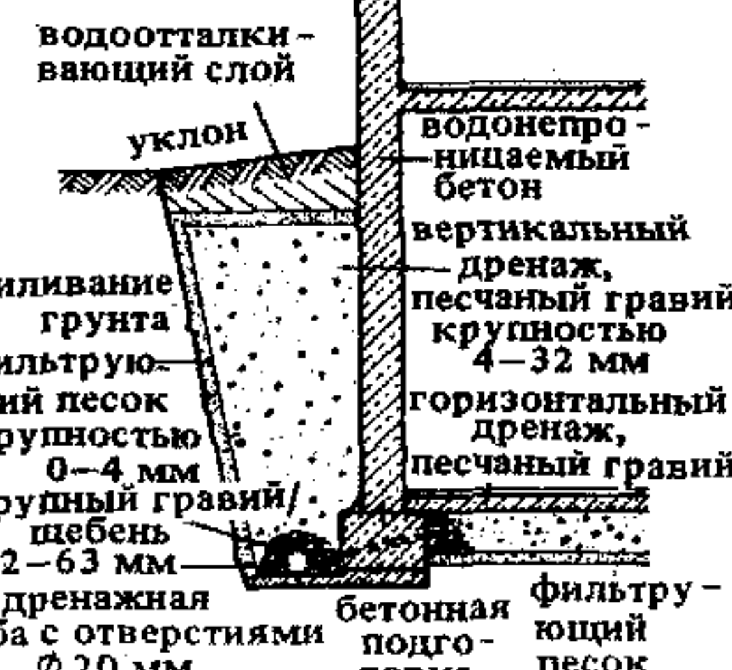
14. Трубчатый дренаж со ступенчатым фильтром
