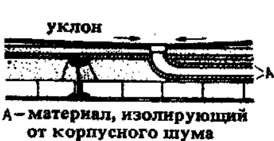
11. Звукоизолирующее крепление оборудования (по Целлеру) А — звукоизоляция от корпусного шума, например резина; Б — воздушная прослойка или прокладка из изоляционного материала
