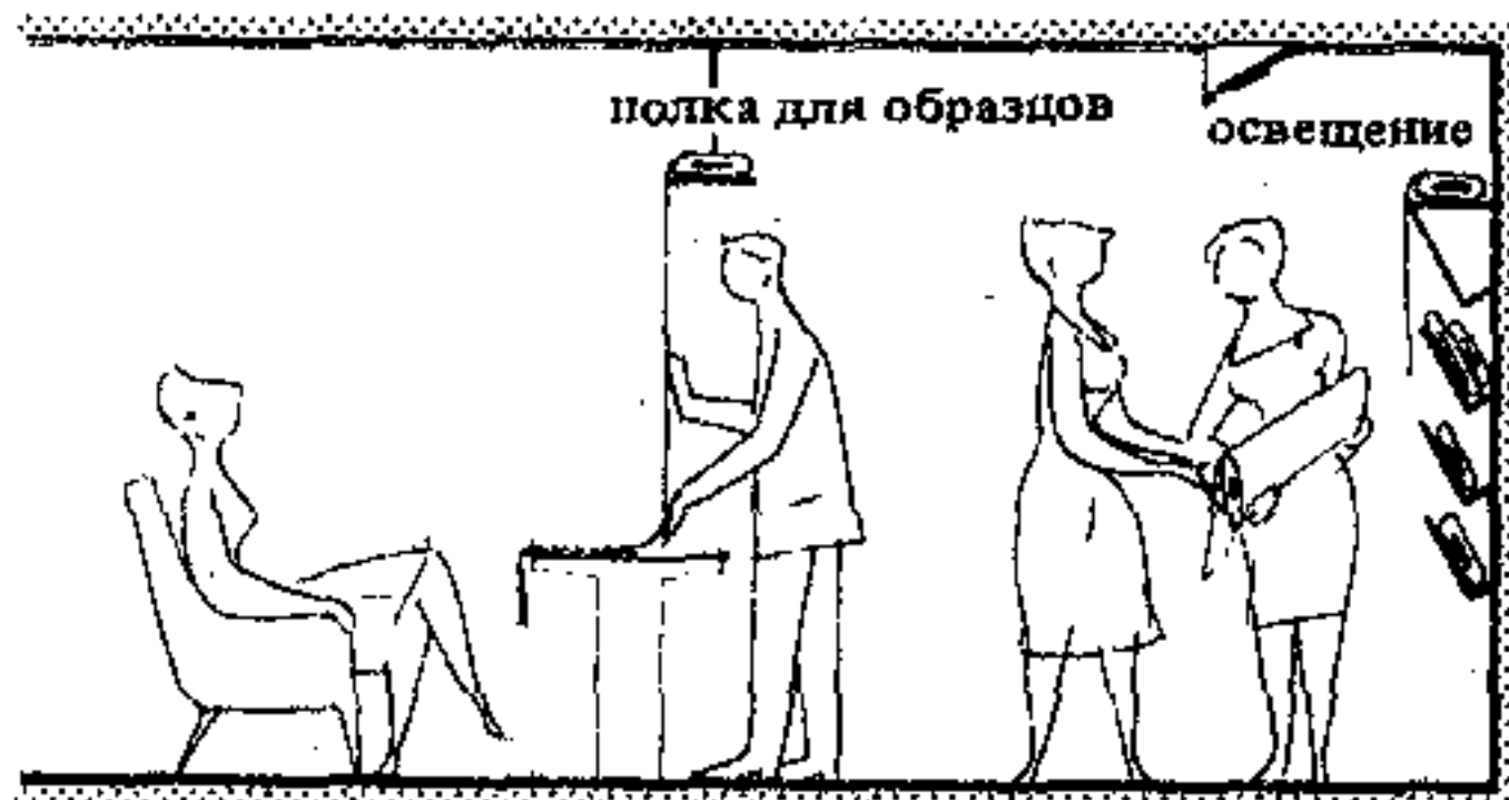
7. Прилавок для демонстрации образцов тканей с подвижной над ним полкой для образцов и настенные полки с бирочками для показа образцов ткани
