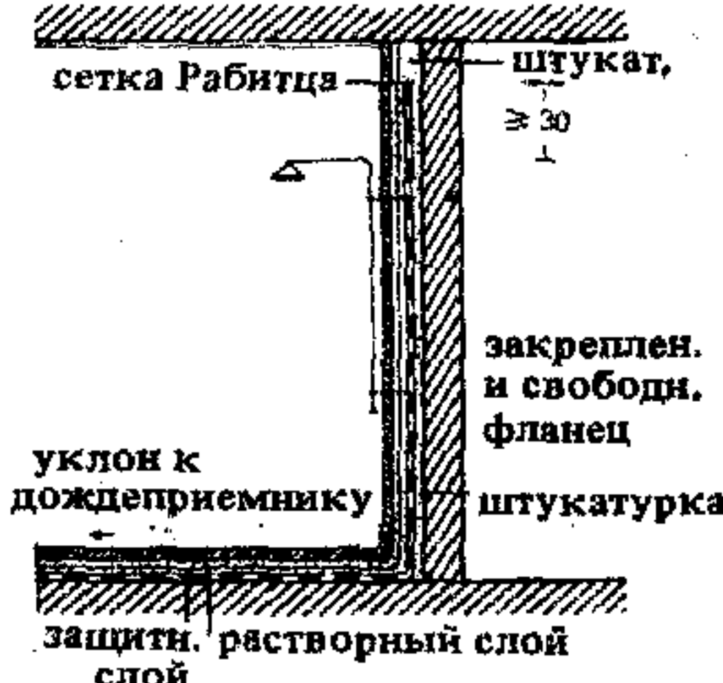
26. Гидроизоляция в душевых кабинках заводится в стену на высоту выше ражка
