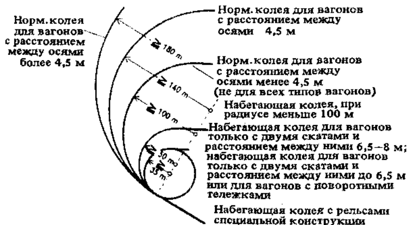
1. Радиусы кривых подъездных железнодорожных путей. В новом строительстве следует избегать применения радиусов менее 100 м. М. 60 км
