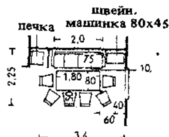
6. Место для отдыха и завтрака в общей комнате с диваном и удобными стульями. Удобная высота стула 44 см, высота стола 70 см
