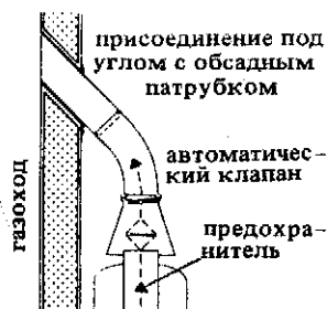
2. Предохранитель и клапан на патрубке присоединения прибора
