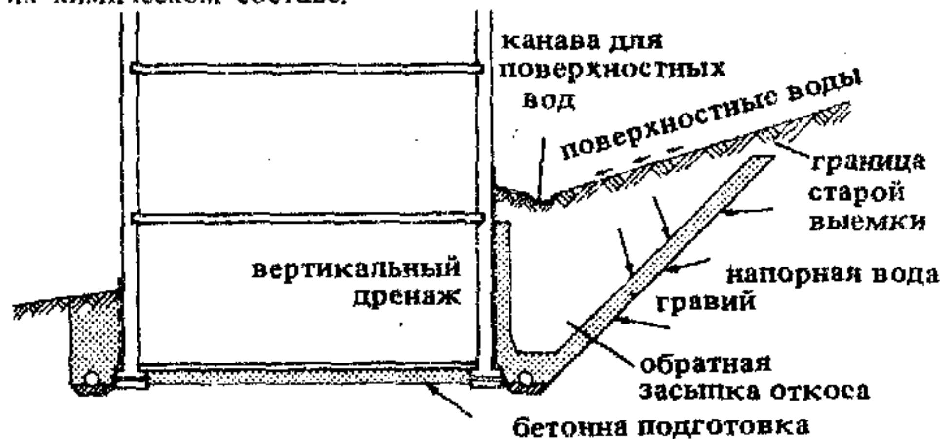
15. Стены подвала с напорной стороны должны быть тщательно изолированы
