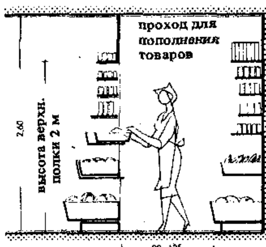
12. Перегородка торгового зала с проходом для пополнения товаров путем смены ящиков
