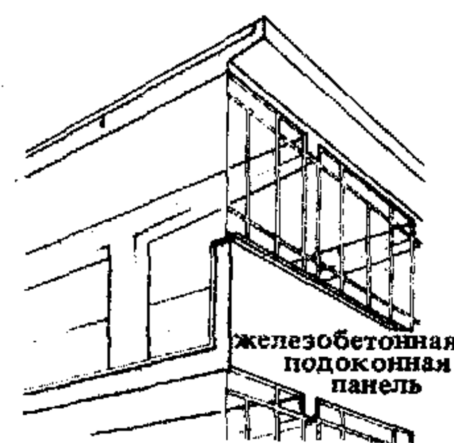
7. Железобетонное здание с целесообразным и экономичным консольным решением покрытия со сплошным легким остеклением
