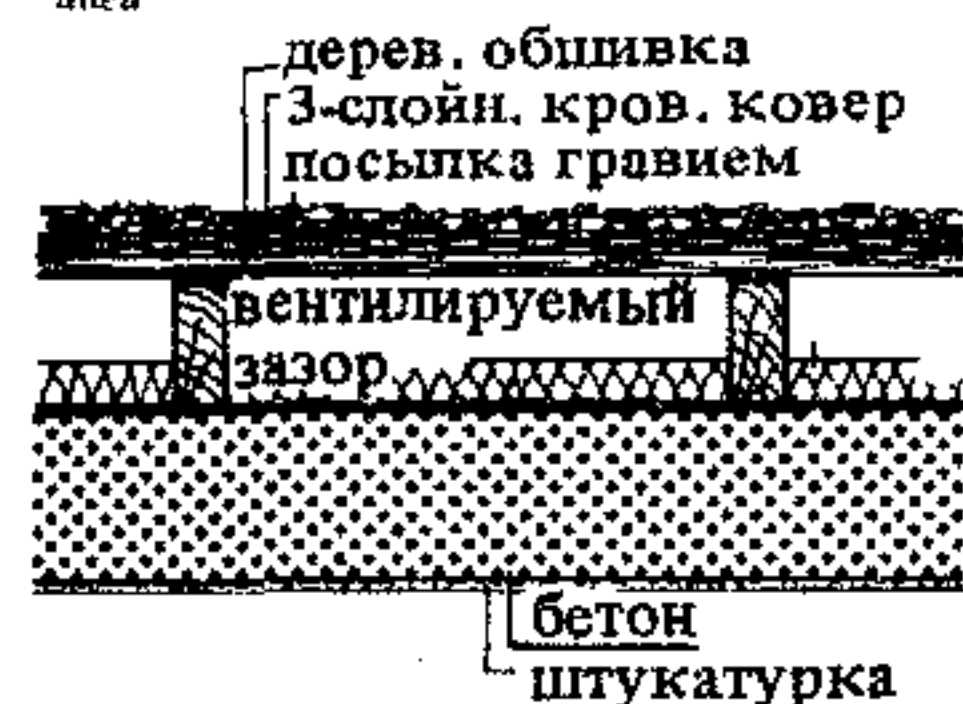
5. Холодная крыша тяжелой конструкции
