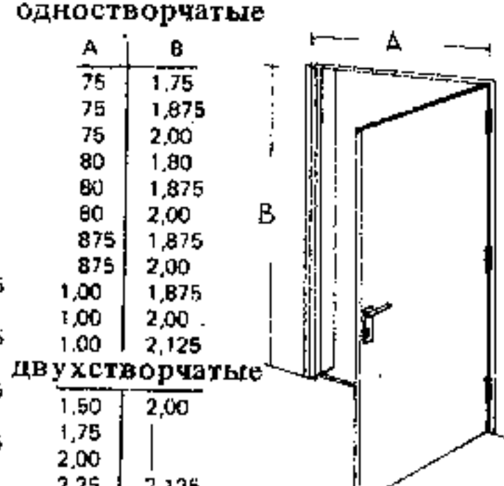
16. Противопожарные двери Т30-Т40
